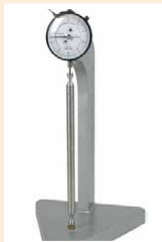
Fotografía del equipo empleado en la estimación del cambio de longitud de muestras de mortero o concreto de acuerdo a la norma ASTM C157.
