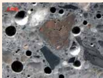
Petrografía contenido de aire en el concreto en estado endurecido (Cortesía Laura Powers, 2014).
