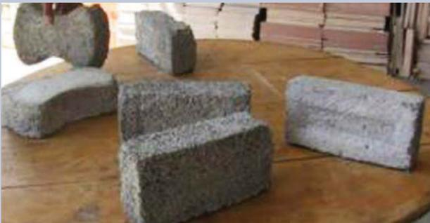
**Ingenieros de la Universidad Nacional Autónoma de México (UNAM)** crearon un ladrillo ecológico mediante un proceso sustentable. En la fabricación del producto se utilizaron residuos de construcción como materia prima y energía solar para el secado, en vez de la cocción tradicional en las ladrilleras.
