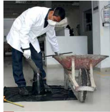
Ensayo de asentamiento de concreto. Llenado del cono de Abrams.
