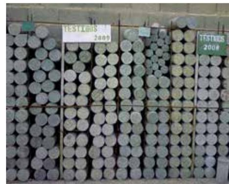
Inadecuado almacenamiento de cilindros testigo.
