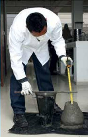
Medida de asentamiento de una mezcla de concreto.
