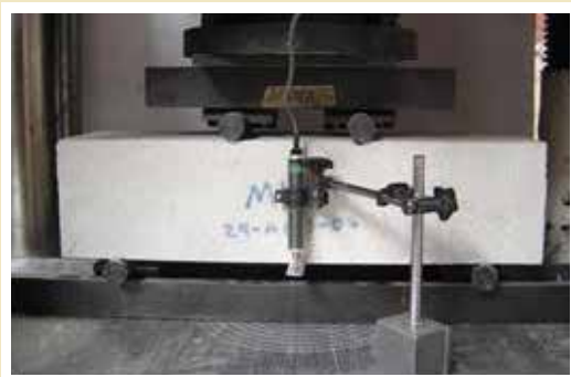
Ensayo a flexión de vigas de concreto.
