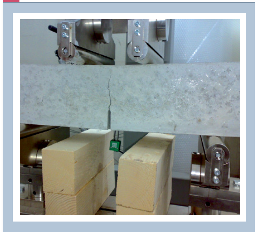
Fig. 4 Imagen del ensayo sobre vigas según el método EN 14651.
