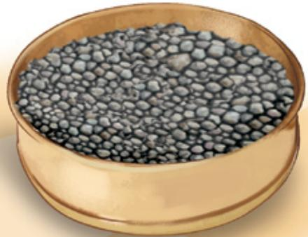
no más del 1% en masa del residuo en cualquier criba individual pase esa criba durante un minuto de cribado, del modo siguiente:
