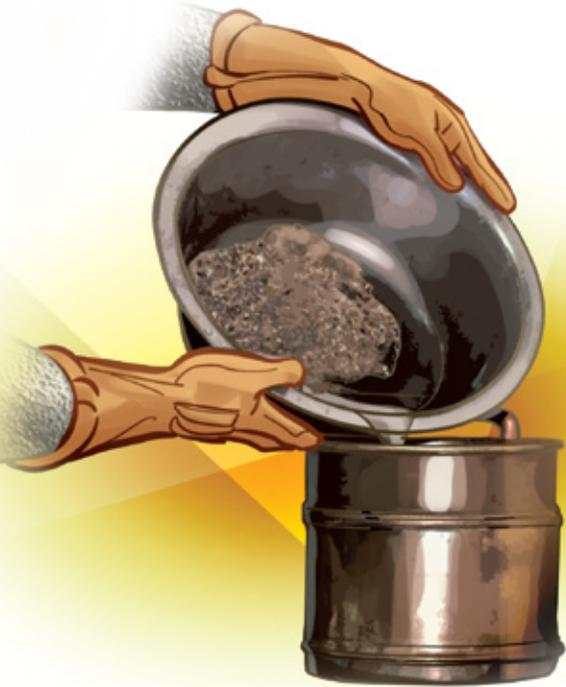
con un aparato mecánico por el tiempo suficiente que satisfaga el criterio de un cribado correcto. Se continúa el cribado por un período suficiente de tal manera que después de haberse completado,
