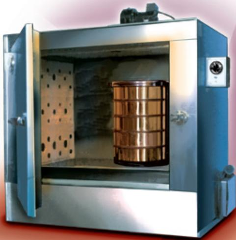
el cribado seco. Después de la operación, la muestra se criba en seco. Finalmente, es determinada la masa retenida en cada criba mediante una balanza o báscula, son calculados los porcentajes hasta los décimos.
