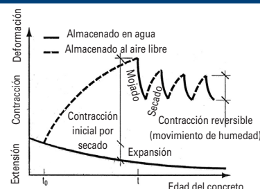
Figura 2. Concreto inicialmente seco, y luego sujeto a ciclos de secado y mojado
