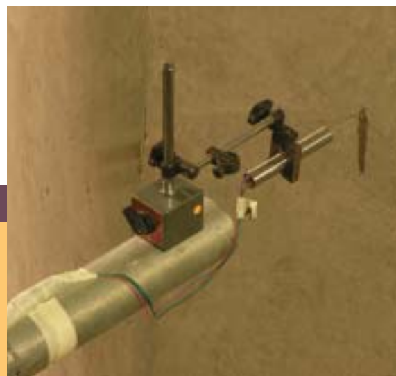
Trasductor de desplazamiento para medir la deformación lateral de la columna durante las pruebas de tracción
