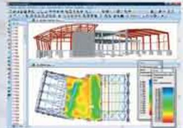
Cálculo sísmico por superposición modal espectral con animación sísmica. Cálculo en 2º orden
