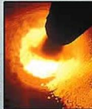
Las teorías termodinámicas y cinéticas modernas indican que la mayoría de las sustancias orgánicas se destruyen en dos segundos a temperatura superior a 1,000° C, por lo que se puede demostrar la efectividad de la utilización del horno de fabricación de cemento, como una opción viable, pues los gases permanecen en condiciones más destructivas que las indicadas.
