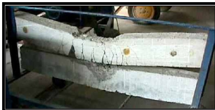
Figura 3. Falla por flexión
