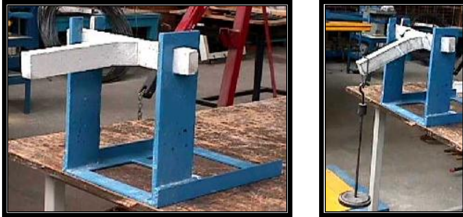
Figura 6. Ensaye de torsión en elementos de concreto
