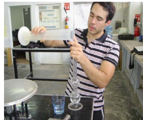
Obtención de densidad de la arena
