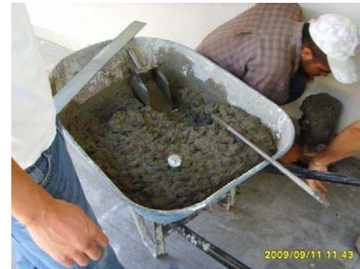
Determinación de temperatura
