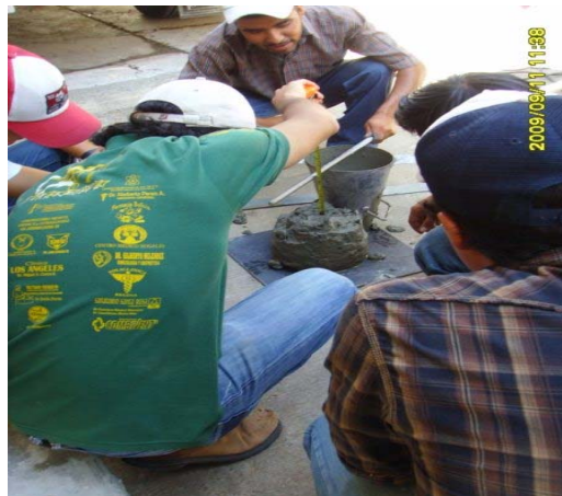
Obtención del revenimiento
