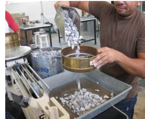
Obtención de la granulometría de gruesos
